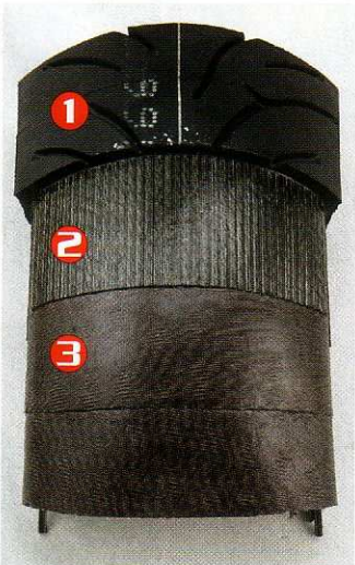
Der neue Gummi ① des Heckpneus, aus zwei unterschiedlich harten Mischungen, liegt über einem Stahlgürtel ②, der wiederum direkt auf der zweilagigen Nylon-Karkasse ③ ruht.
