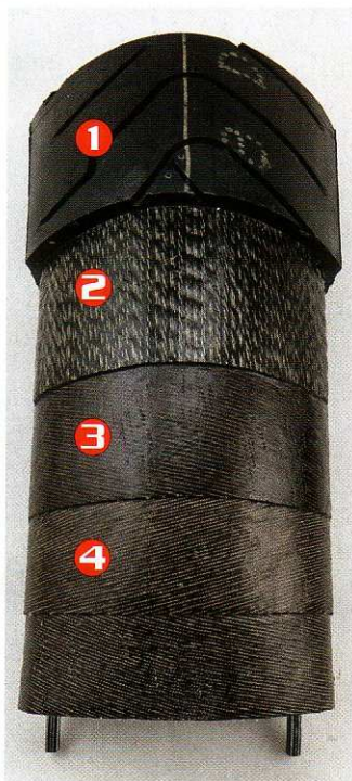
Unter der neuen Gummimischung ① liegt beim Frontpneu der Stahlgürtel ②, darauf folgt eine Nylon-Zwischenlage ③, darunter die zweilagige Rayon-Karkasse ④.
